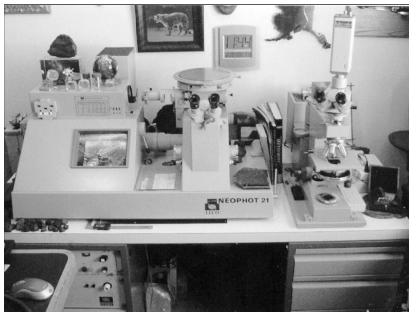
Mikroskop z Jeny Neophot 21 do fotografowania w świetle odbitym. Z prawej mikroskop z Jeny Fluoval wykorzystywany do oglądania płytek cienkich.
