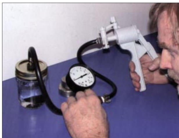
Fot. 1. Niedrogi aparat do pomiaru średniej gęstości, porowatości i gęstości ziaren meteorytów.
