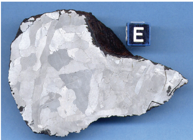
Wytrawiony przekrój szrapnela ze zdjęcia wyżej z widocznymi deformacjami figur Widmanstättena.
