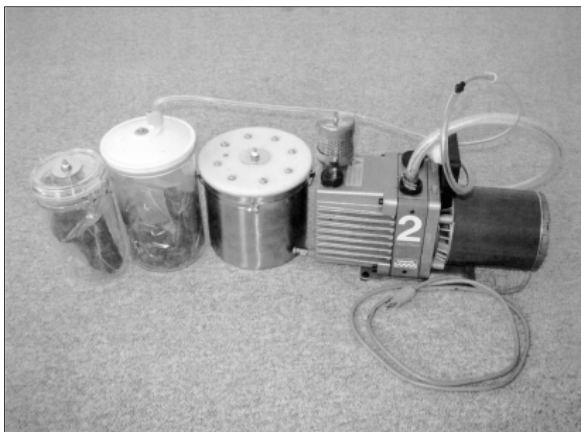
Fot. 4. Trzy rodzaje pojemników próżniowych z meteorytami i pompa, która została użyta do wytworzenia wysokiej próżni w pojemnikach. Dalsze wyjaśnienia w tekście.
