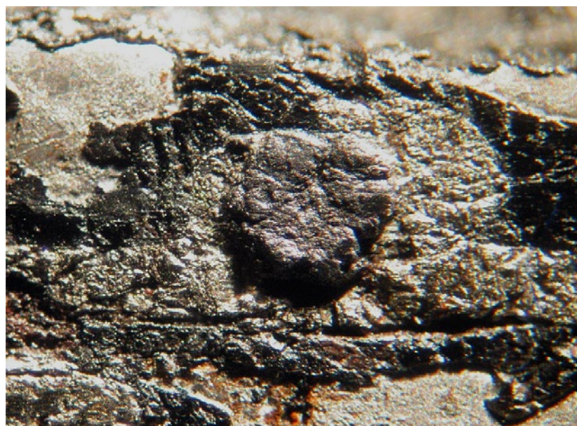
Bryłka w centrum wystaje ponad otoczenie i widać, że przy jej brzegach są twardsze cząstki. Po przebadaniu podobnych cząstek stwierdzono, że zawierają one przerastające się warstwy lonsdaleitu i diamentu. (Szczegół z poprzedniego zdjęcia).
