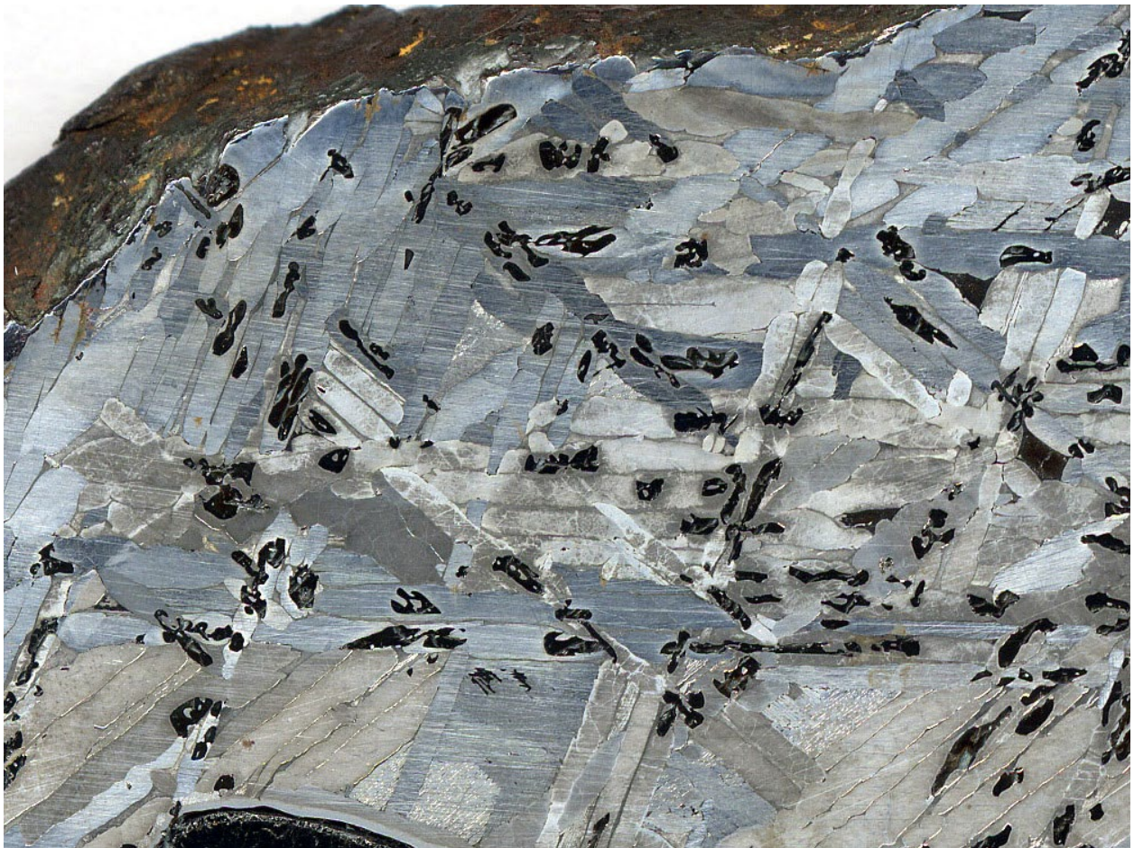
Plamki, które tu są ciemne, w płytkach kamacytu, zawierają węgiel. Jest to cohenit, węgiel żelaza, niklu i kobaltu (Fe, Ni)_3C . Haxsonit (Fe, Ni)_{23}C_6 jest innym węglikiem znalezionym w Odessie i innych meteorytach. Przy odpowiednim oświetleniu oba minerały mają srebrzystą barwę. Fragment meteorytu Odessa o szerokości 43 mm.
