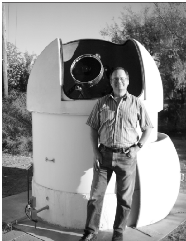
Fot. 1. Roy Tucker i pierwsze obserwatorium zainstalowane na jego podwórku. Teleskop to Celestron 14 ze zmodyfikowanym napędem Byersa. Kamera CCD została zaprojektowana i zbudowana przez Roya. Przy pomocy tego teleskopu Roy odkrył swoje trzy pierwsze NEO.
