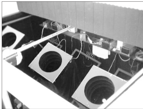
Fot. 2: Tempo poszukiwań planetoid zwiększyło się w roku 2001, gdy zaczął działać MOTESS (System szukania poruszających się obiektów i chwilowych zjawisk). Złożony z trzech teleskopów o średnicy 35 cm każdy, z kamerami CCD nieprzerwanie tworzącymi obrazy, system ten może przebadać ponad sto stopni kwadratowych nieba w ciągu nocy. Przez pięć lat dostarczył prawie ćwierć miliona obserwacji pozycji planetoid i komet.
