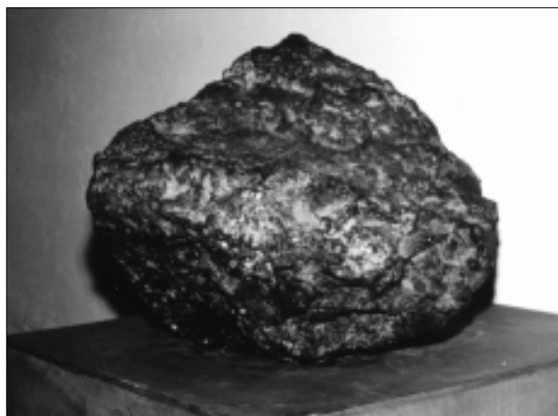
Fot. 2. Jeden z produktów „topienia surowego” rudy miedzi w hucie w Leszczynie w 2 poł. XIX w. — zredukowane żelazo, bogate w kobalt i nikiel. Odwrotna strona okazu z fot. 1.
