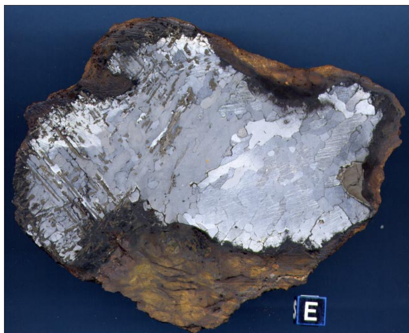
Fot. 11. Piętka po wytrawieniu. Z lewej liczne paski cohenitu w metalu i w zwietrzelinie, w środku dwie długie inkluzje schreibersytu, z prawej fragment inkluzji troilitu ze schreibersytową otoczką.
