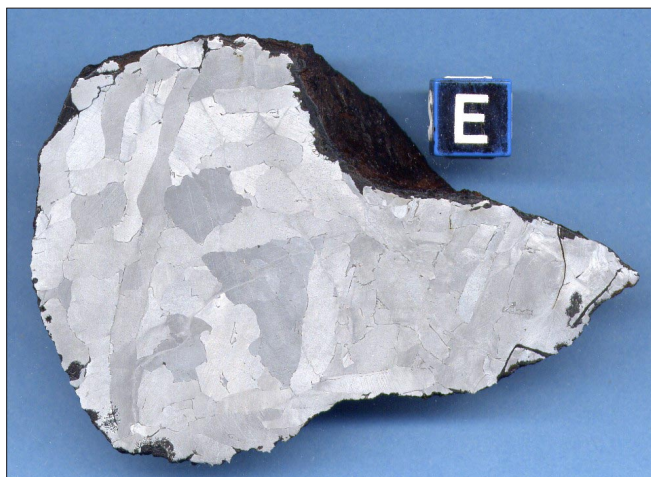
Fot. 2. Wytrawienie powierzchni przekroju rozwiło wątpliwości. Widoczne szokowe deformacje figur.
