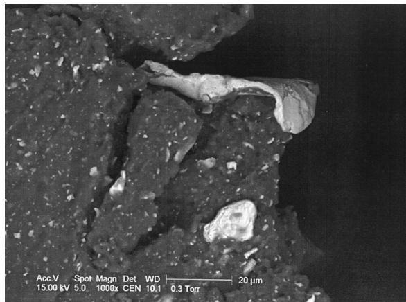
Rys. 9. Obraz spod elektronowego mikroskopu skaningowego twardej smolistej substancji wydzielonej z jednej z trzech hydrofobowych grudek torfu zabarwionej hematytom na rudy kolor. Substancja jest naszpikowana cząstkami Cu_3Zn_2 od submikroskopowej wielkości do około 50 µm długości. Fot. Mariola Jabłońska
